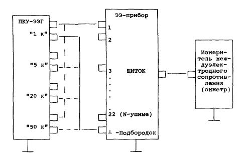
Измеритель междуэлектродного сопротивления (омметр) признарт годным, если относительная погрешность не превышает 10 \$ или значения, установленного в ЭД на поверяемый ЭЭ-прибор.
