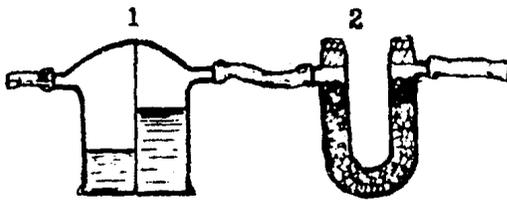
Рис. 3 Очистительная система. 1-сдвиг Тиченко, 2- поглотитель с натронной известью.
