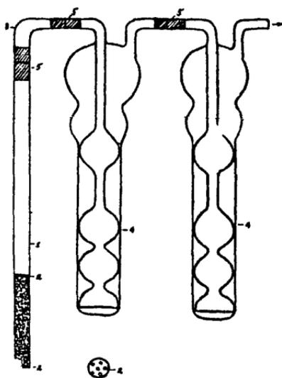
Рис. 5. Схема установки для отбора пробы воздуха.
