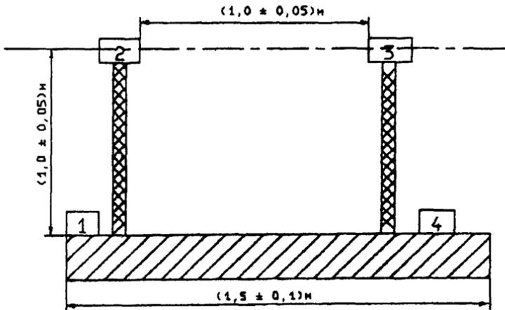
Стенд для проведения испытаний по измерению звукового давления:
