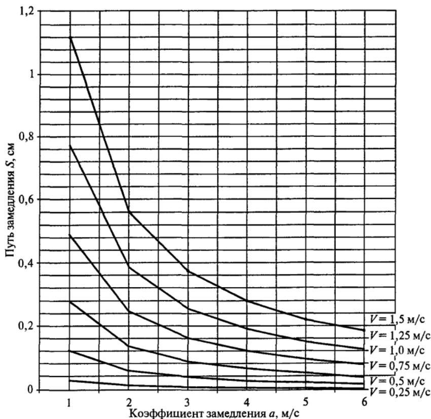
Рис. 3. Зависимость коэффициента и пути замедления от скорости движения крана
