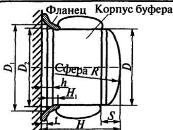
Пример условного обозначения. Буфер диаметром 40 мм. Буфер БР40 по ОСТ 24.191.37–78
