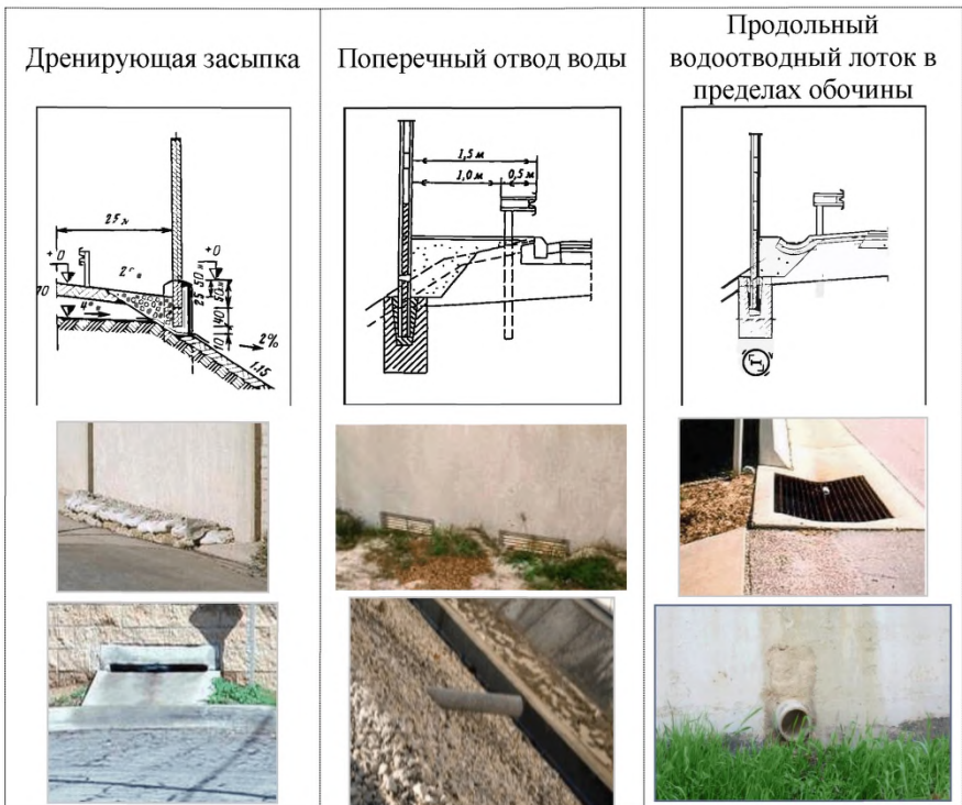
Рисунок 11.42 - Организация отвода воды
