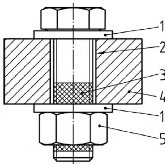
1 – контрольная шайба по ГОСТ 11371; 2 – сквозное отверстие 2-го ряда по ГОСТ 11284; 3 – МК-покрытие; 4 – контрольная втулка с наружным диаметром не менее двух номинальных диаметров резьбы  $d$  и твердостью не менее 35 HRC; 5 – контрольная гайка по ГОСТ ISO 4032 или ГОСТ ISO 8673
