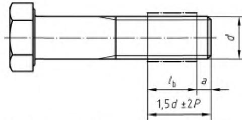
$l_b$  – длина МК-покрытия;  $d$  – номинальный диаметр резьбы;
