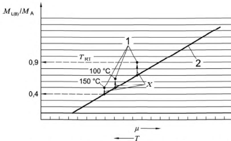
1 – испытание с МК-покрытием; 2 – базовое испытание без МК-покрытия;  $T_{RT}$  – комнатная температура; X – стопорящее действие клея;  $M_{L(B)}/M_A$  – соотношение крутящего момента при отвинчивании несклеенного болтового соединения (крутящего момента при отвинчивании склеенного болтового соединения) к крутящему моменту затяжки;  $\mu$  – коэффициент трения;  $T$  – температура
