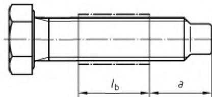
$l_b$  – длина МК-покрытия;  $a$  – расстояние до МК-покрытия от конца болта
