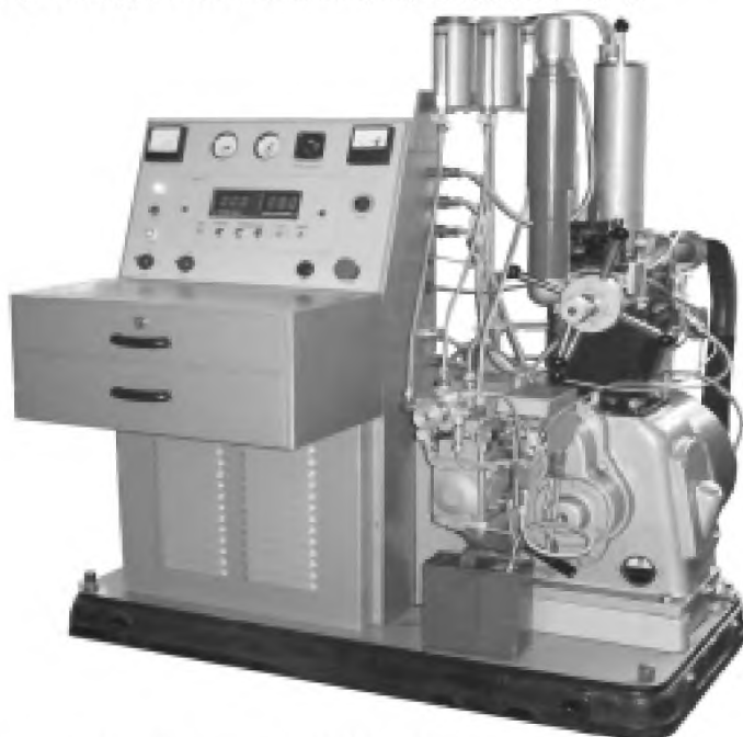
Рисунок 1 — Установка ИДТ-90 для определения цетанового числа
