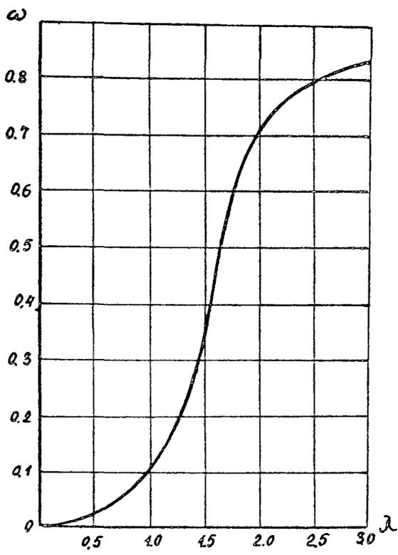
Рис.4. Значение коэффициента  $\omega$  в зависимости от показателя гибкости конструкций здания  $\lambda$
