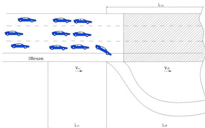
Рисунок 2. Схема движения транспортного средства при объезде
