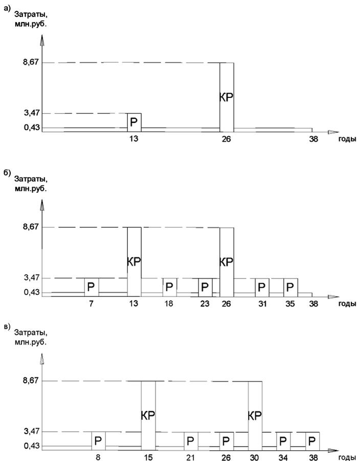
Рисунок Б.1. Сроки выполнения и затраты на ремонт дорожных одежд по вариантам а – с цементобетонным покрытием, б – с асфальтобетонным покрытием (по традиционной технологии), в – с асфальтобетонным покрытием (по инновационной технологии)
