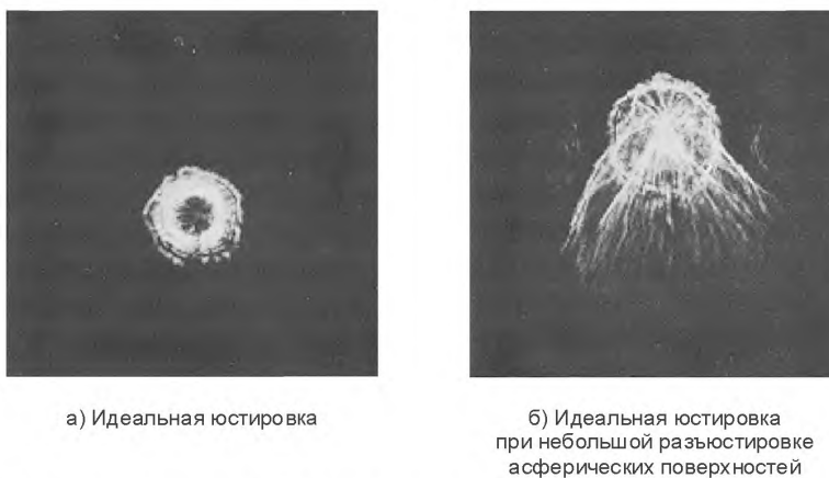
Рисунок 17 — Поперечное сечение пучка вблизи плоскости его максимального ограничения (легкая расфокусировка)
