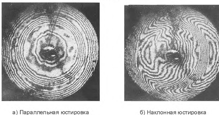
Рисунок 16 — Расхождение двух асферических поверхностей (искажения, вносимые интерферометром, исключены)
