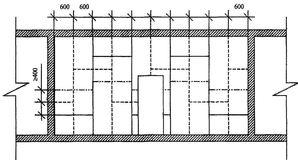
**Рисунок 14** — Схема расположения ГКЛ перегородки С 113 (сплошные линии — листы первого слоя, пунктирные — листы второго слоя, штрихпунктирные — листы третьего слоя; второй слой смещен относительно первого на один шаг стойки)
