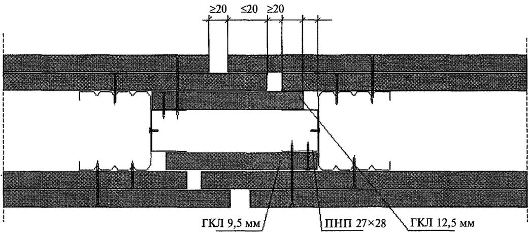
**Рисунок 11** — Схема устройства деформационного шва в перегородке С 112
