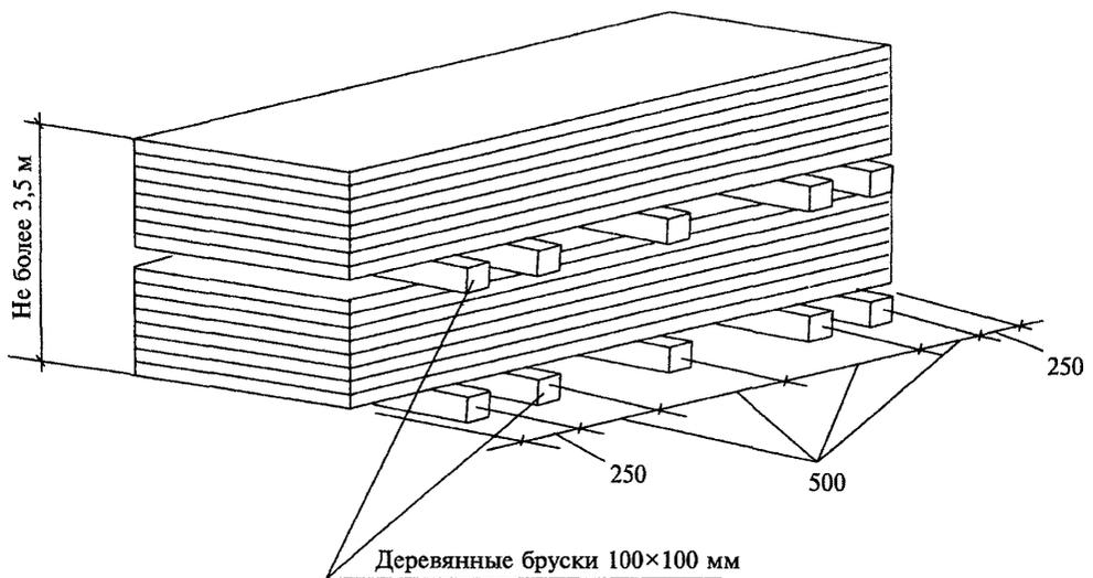
**Рисунок 2** — Схема складирования ГКЛ на объекте
