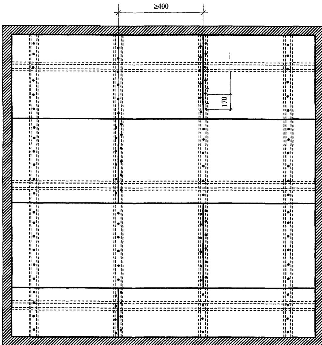
*Рисунок 33* — Схема расположения листов ГКЛ и самонарезающих винтов в подвесных потолках
