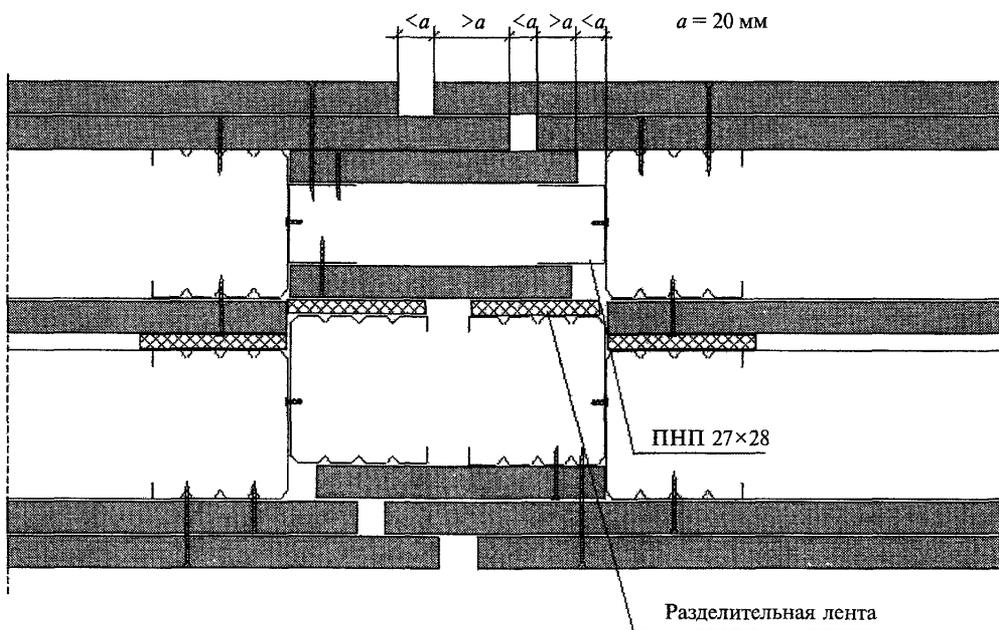
Рисунок 20 — Схема устройства деформационного шва в перегородке С 115.2
