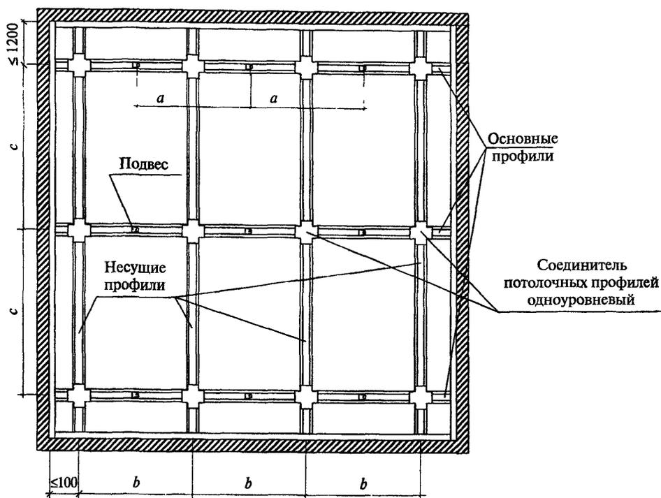
Межосевые расстояния при устройстве каркаса
