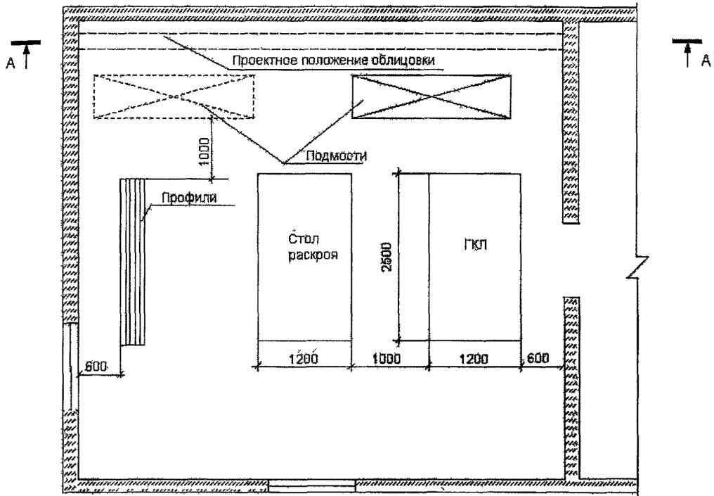
Рисунок 22 — Схема организации рабочего места при облицовке стен
