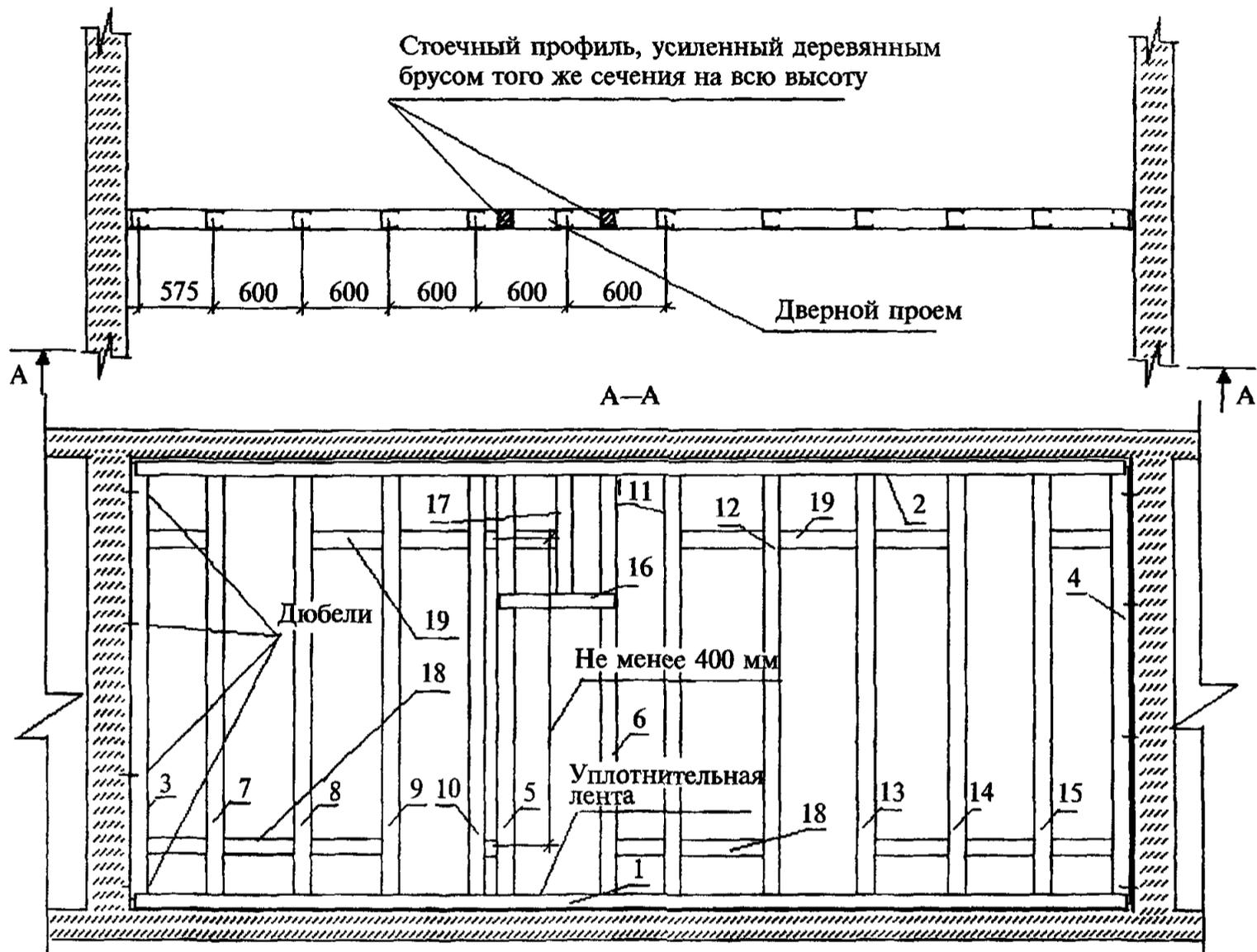
1 — ПН на полу; 2 — ПН на потолке; 3, 4 — ПС, примыкающие к конструкциям здания; 5, 6 — ПС, ограничивающие дверной проем; 7, 8, 9, 10, 11, 12, 13, 14, 15 — монтаж профиля каркаса с сохранением проектного шага; 16 — монтаж перемычки над дверным проемом; 17 — монтаж ПС с сохранением шага над дверным проемом; 18, 19 — монтаж горизонтальных вставок из ПН под горизонтальные швы ГКЛ
