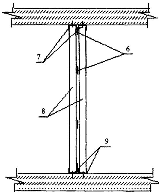
1 — направляющие пола и потолка; 2 — стойки несущего каркаса; 3 — первый слой ГКЛ с двух сторон; 4 — второй слой ГКЛ с двух сторон; 5 — разделительная лента; 6 — уплотнительная лента; 7 — профиль направляющий потолка; 8 — профиль стоечный; 9 — профиль направляющий пола
