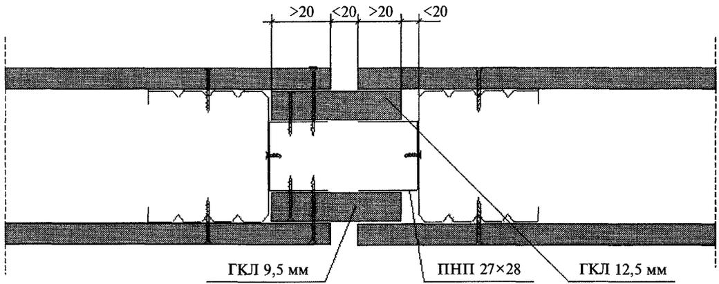
**Рисунок 10** — Схема устройства деформационного шва в перегородке С111
