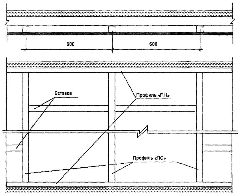
Рисунок 26 — Схема монтажа каркаса в облицовке С 625
