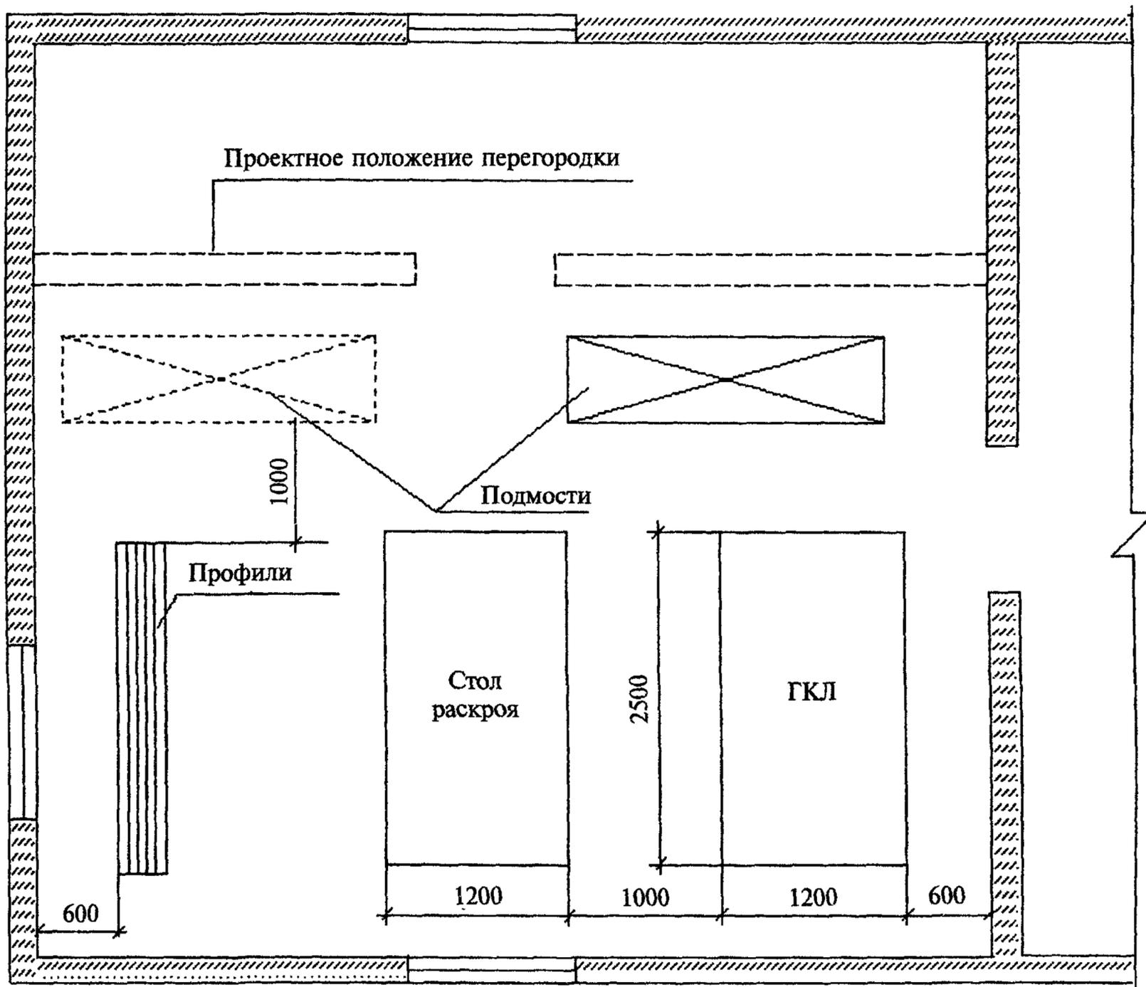
Рисунок 3 — Схема организации рабочего места
