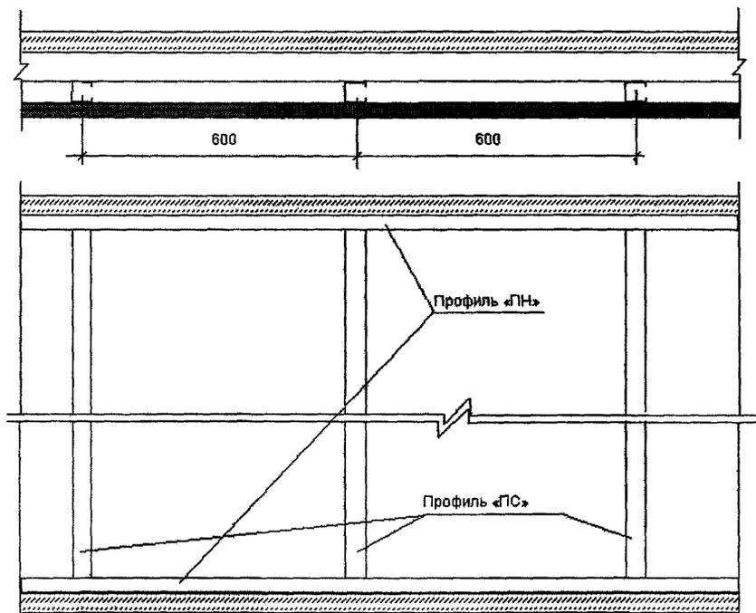
Рисунок 27 — Схема монтажа каркаса в облицовке С 626
