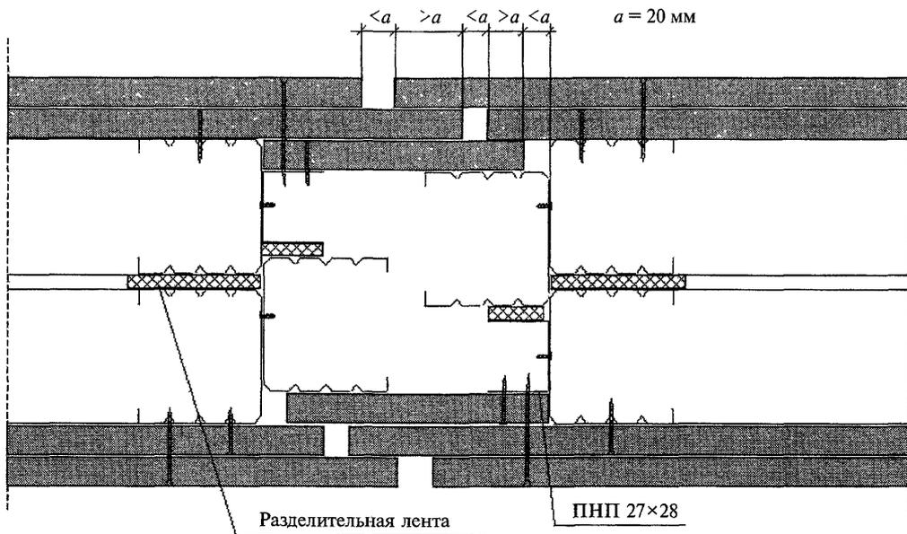
Рисунок 19 — Схема устройства деформационного шва в перегородке С 115.1
