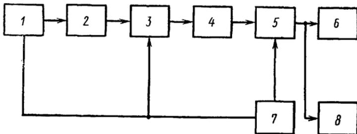
1—генератор; 2—преобразователь; 3—компенсатор; 4—измерительный усилитель;
