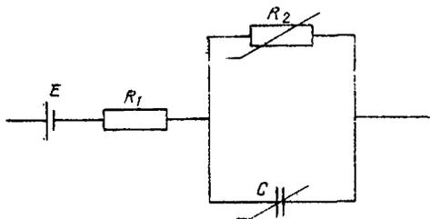
$E$ —источник э.д.с.;  $R_1$ —фиксированное сопротивление в заданный момент срока службы элемента, зависящее от проводимости смесей, электролитов, токоотводов и т. д.;  $R_2$ —сопротивление, связанное с поляризацией, значение которого уменьшается по мере увеличения тока;  $C$ —конденсатор, емкость которого уменьшается по мере увеличения силы тока
