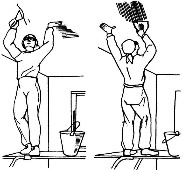
Упираясь левой рукой в потолок, а правой прижимая лезвие широкого шпателя к поверхности потолка под углом в 30°, маляр ведет его вперед, нанося шпаклевочный состав на поверхность потолка. Подмазку трещин и выравнивание нанесенного слоя производят движениями узкого шпателя поперек и вдоль трещины. По ходу работ маляры переставляют свои столики-подмости
