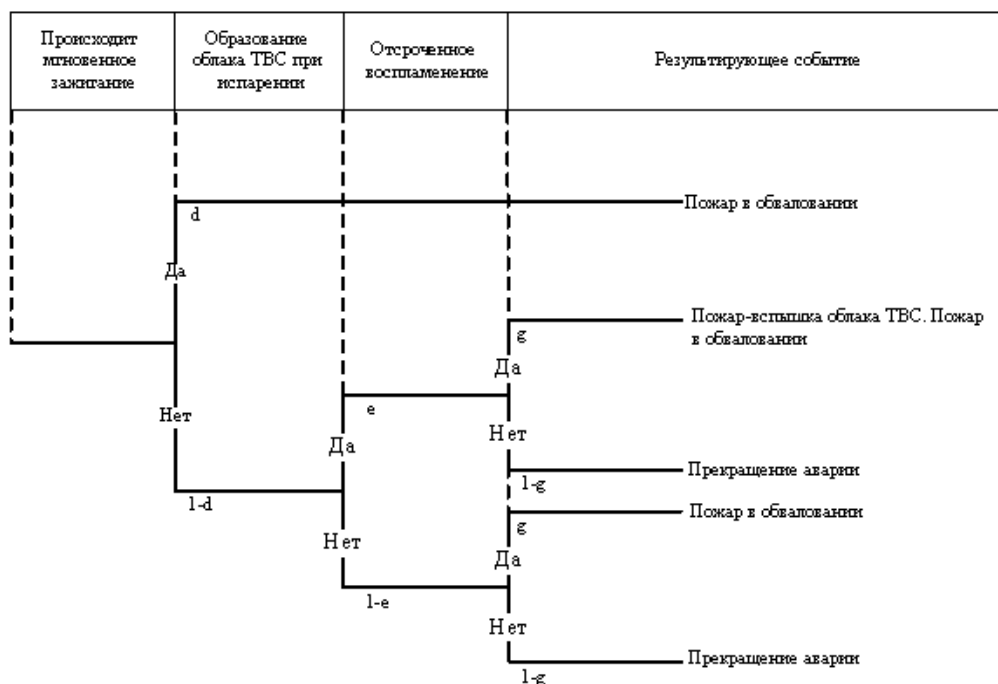
Рис. 4 "Дерево событий" разрушения/перелива подземного резервуара (сценарий А 4 )
