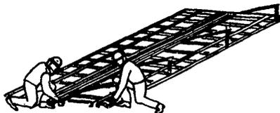
3 СМАЗКА ОПАЛУБКИ; 35 мин; С<sub>1</sub>, С<sub>2</sub>; строп, компрессор, пистолеты-распылители, лестницы-стремянки
