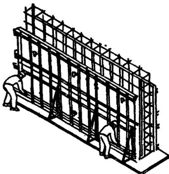
Слесари С<sub>1</sub> и С<sub>2</sub> принимают поданную машинистом крана панель и устанавливают ее в проектное положение, при этом слесарь С<sub>1</sub> держит отвес, а слесарь С<sub>2</sub> подкручивает домкратные винты. Таким образом вставляют три панели с одной стороны арматурного каркаса, а затем три панели с другой стороны
