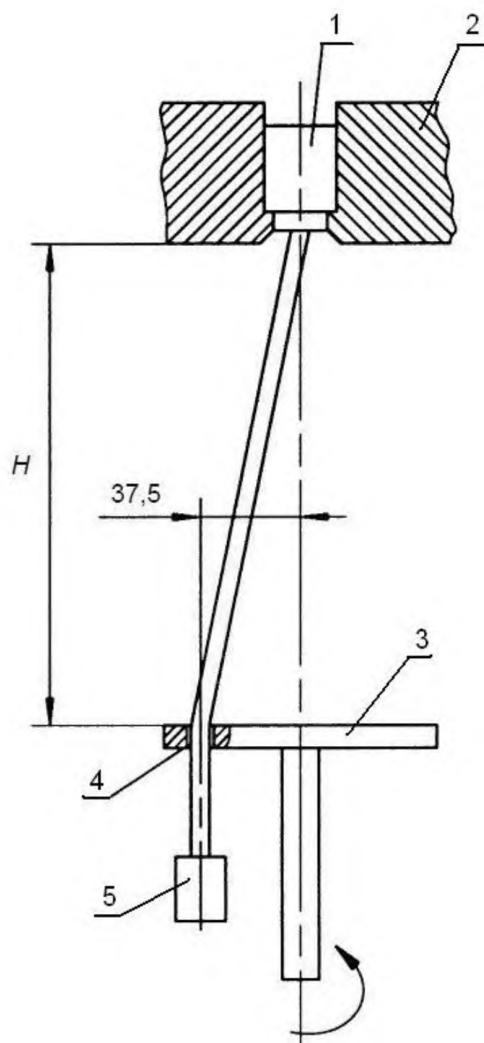
1 — испытуемое устройство УСС; 2 — крепление; 3 — плата; 4 — втулка; 5 — груз
