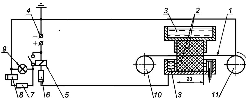
1 — провод; 2 — фетровые пластины; 3 — ванна с раствором электролита (30 г  $\text{Na}_2\text{SO}_4$  на 1  $\text{дм}^3$  воды); 4 — источник постоянного тока; 5 — реле; 6, 7 — резистор, 50 кОм; 8 — счетчик; 9 — сигнальная лампа; 10 — отдающая катушка с проводом; 11 — приемная катушка
