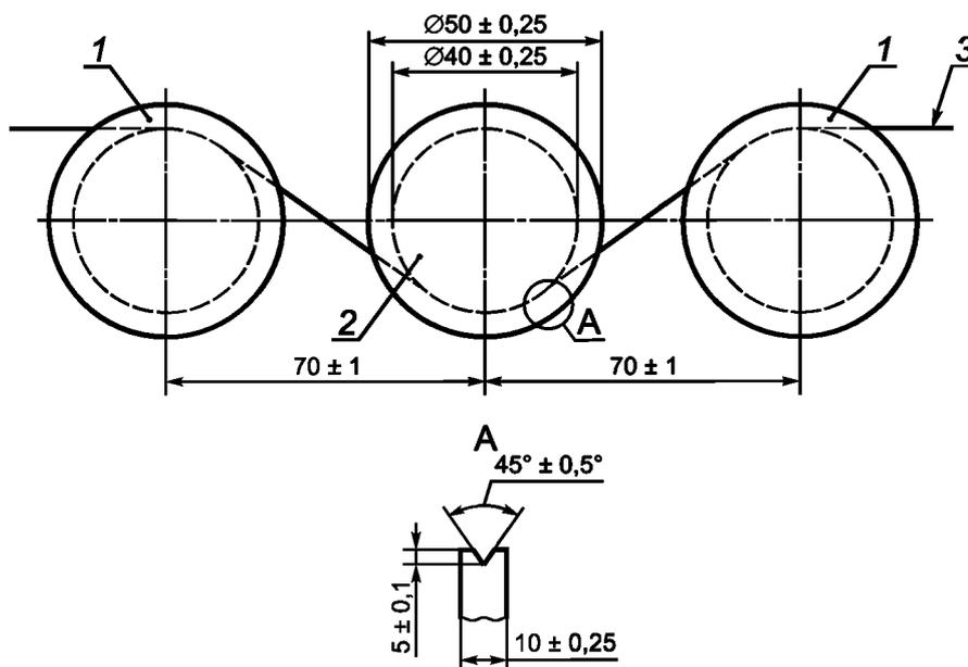
1 — направляющий ролик; 2 — электрод; 3 — образец провода
