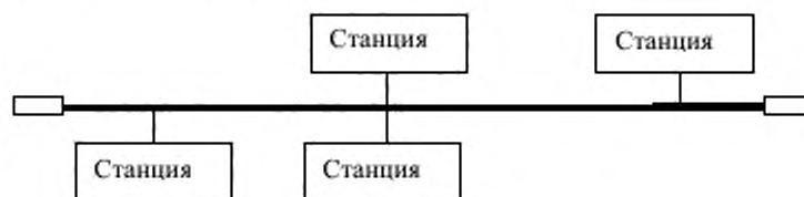
Рисунок 5 –Топология «шина»
