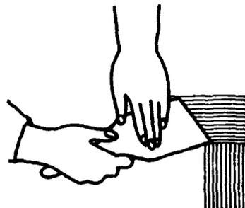
жениями, противоположными нанесению шпаклевки, он сглаживает нанесенный слой шпаклевки и снимает излишки. Для окончательного сглаживания маляр использует универсальный шпатель с резиновой вставкой, которым он перекрывает каждую предыдущую полосу на 2-3 см
