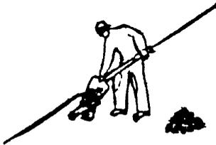
4. Засыпка трещин высевкой С-5 мм.
