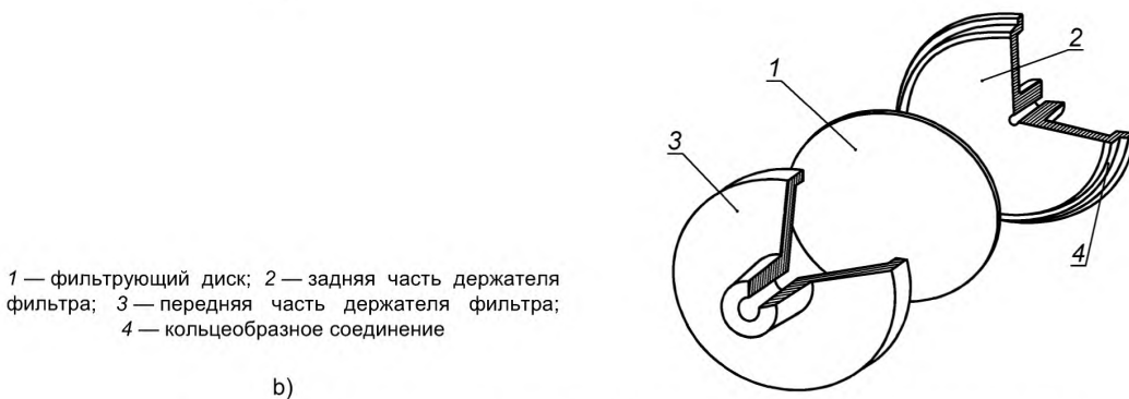
Рисунок 4 — Схема ловушки для дыма с фильтрующим диском из стекловолокна
