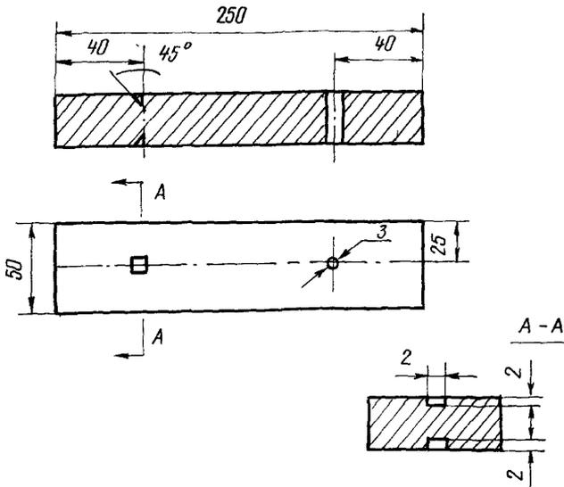
Рис.1. Испытательный образец для настройки дефектоскопа
