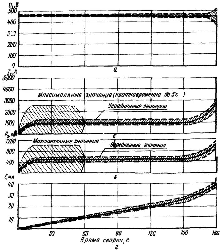
Рис.6. Диаграмма режима сварки: а-напряжение на первичной обмотке; б-первичный ток сварочного трансформатора в процессе оплавления; в-активная мощность сварочной цепи; г-перемещение подвижной части машины
