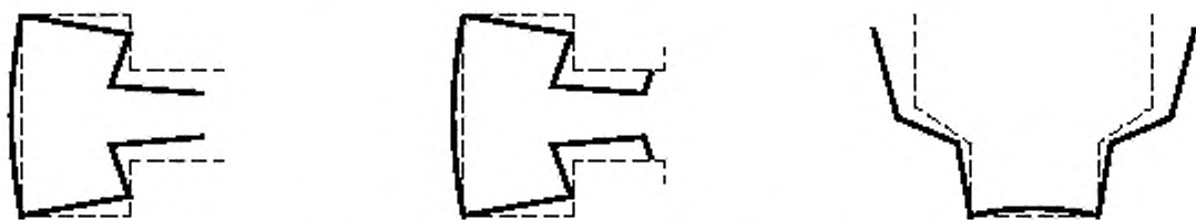
Рисунок 15 — Потеря устойчивости сечения сложной формы
