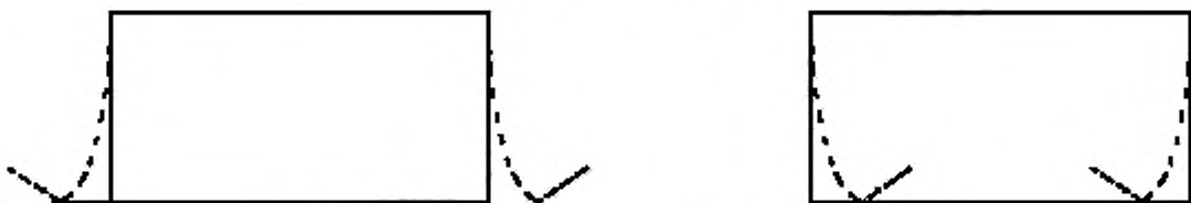
Рисунок 14 — Потеря устойчивости сечения простой формы
