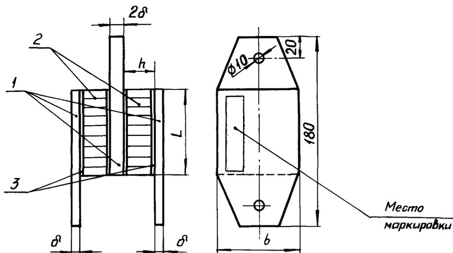
1 - плита; 2 - сотовый наполнитель; 3 - обшивка
