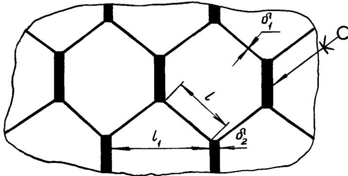
$l$  - ширина грани сотовой ячейки;  $\delta_1$  - толщина одинарной грани сотовой ячейки;  $\delta_2$  - толщина двойной грани сотовой ячейки;  $l_1$  - расстояние между гранями двойной толщины
