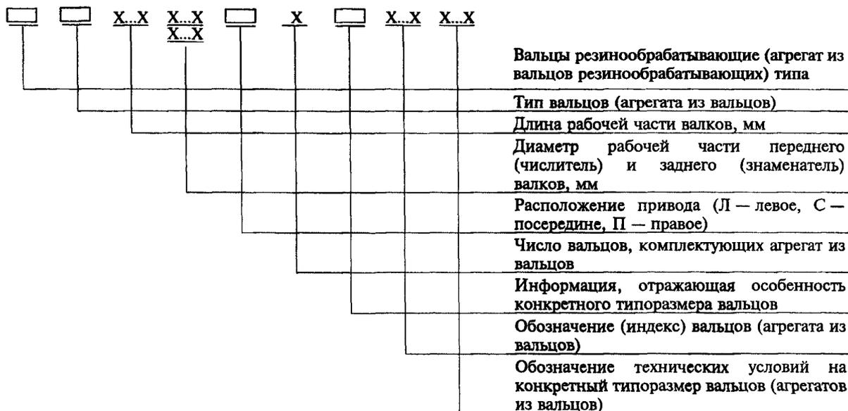
Пример наименования для написания в технической документации резинообрабатывающих вальцов типа Пд с длиной рабочей части валков 2100 мм, диаметрами рабочей части переднего и заднего валков 660 мм, с левым расположением привода:
