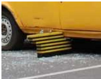
ТС остались на полотне дороги с опорой на все колеса, поэтому для стабилизации ТС необходимо установить опорные блоки и подложить клинья под колеса.
