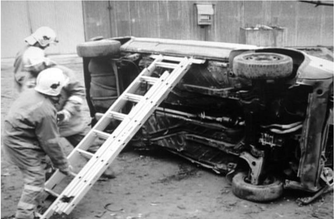
Рис. 6. Стабилизация ТС, лежащего на боку в результате ДТП
