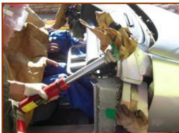
Сдвиг приборной панели автомобиля осуществляется для облегчения эвакуации пострадавших или получения доступа к их ногам. Для этого вставляется дополнительный упор из подкладок под среднюю стойку, в то место, куда будет направлено усилие от нижнего упора гидроцилиндра.
