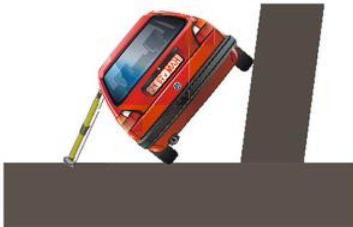
ТС наехало на неподвижное препятствие. Для предотвращения опрокидывания ТС необходимо установить стандартную крепь или лестницу.
