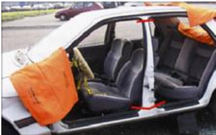
В данном типе ДТП с целью создания доступа для оказания помощи пострадавшим или для их немедленной эвакуации (если это необходимо) проводится демонтаж дверей с обеих сторон автомобиля. Для этого следует снять передние двери со стороны пассажира и водителя с помощью резания или разжима дверных петель.
