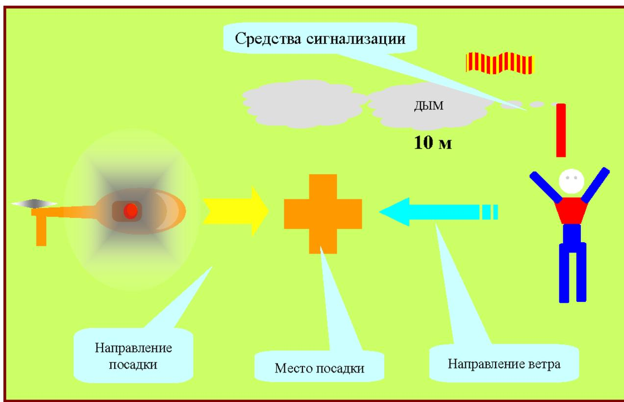
Рис. 17. Схема организации приема вертолета на место ДТП
