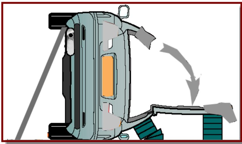
В данном типе ДТП с целью создания доступа для оказания помощи пострадавшим или для их немедленной эвакуации (если это необходимо) проводится демонтаж боковой стороны автомобиля. Для этого следует снять переднюю и заднюю двери со стороны водителя с помощью резания или разжима дверных петель.
