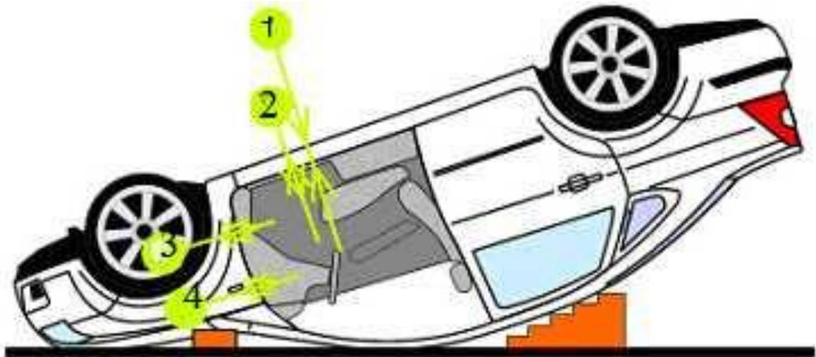
Сдавить пороги автомобиля, чтобы создать пространство, необходимое для наконечников расширителя (1).
