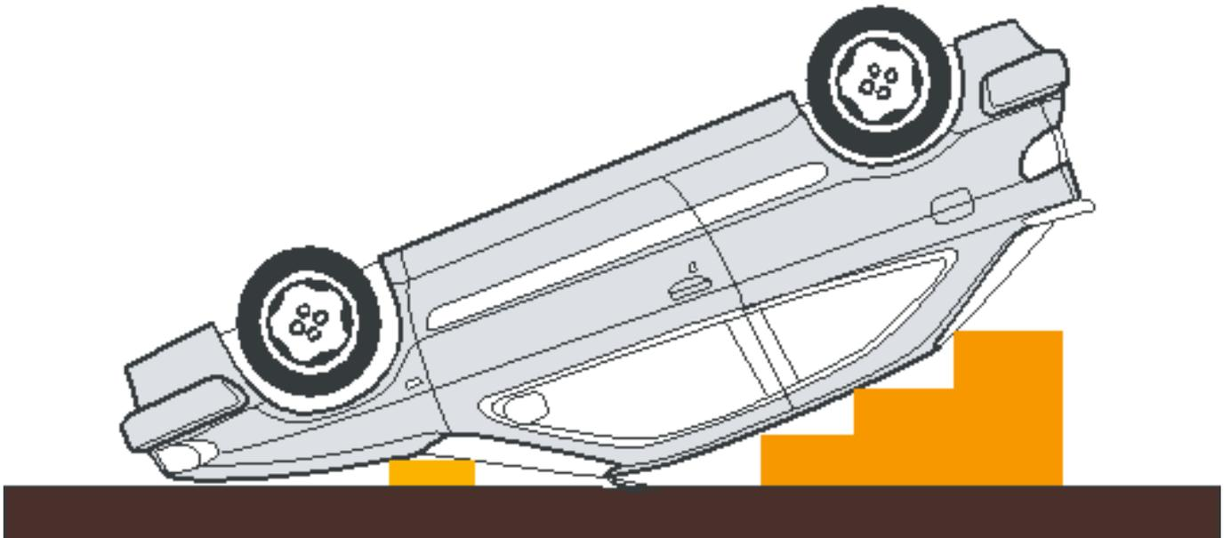
Рис. 7. Стабилизация ТС, опрокинутого на крышу в результате ДТП
