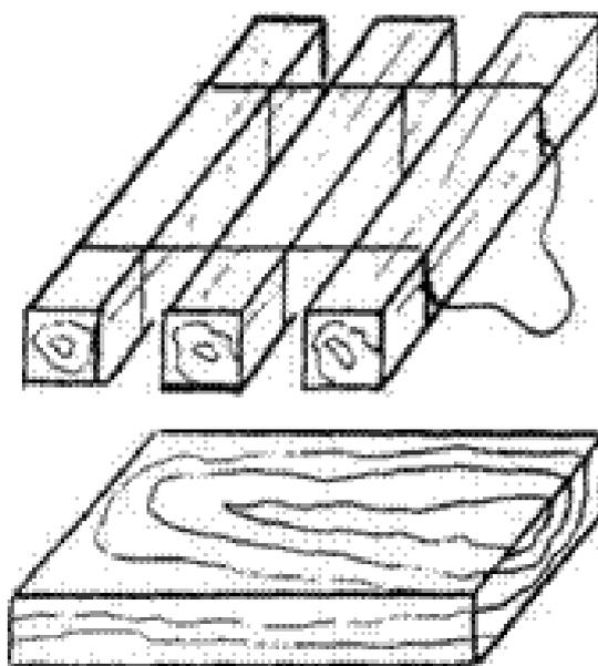
Для гарантии того, что автомобиль не перевернется, необходимо установить опоры под передней и задней стойками лежащего автомобиля. Подпереть днище автомобиля механическими распорками (из дерева или металла), или использовать гидравлические или пневматические стойки (крепь).
