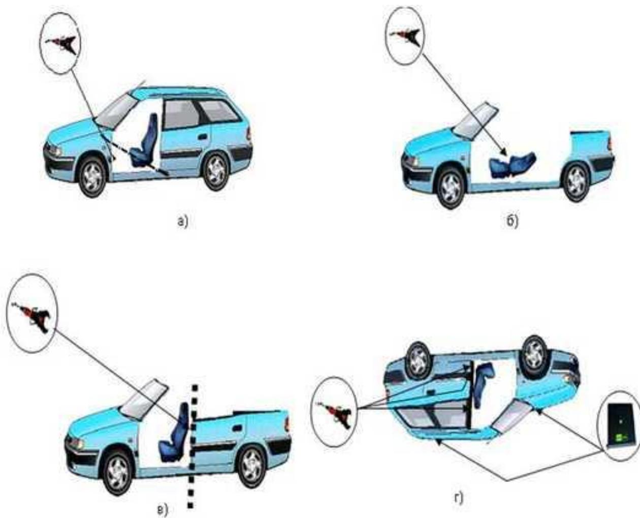
Рис. 13. Схема резки: а) переднего крыла; б) спинки переднего сидения; в) опоры средней стойки; г) опоры средней стойки и спинки переднего сидения
