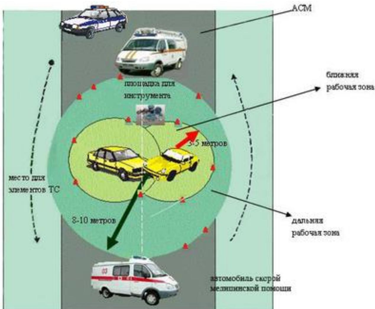
Рис 4. Типовая схема организации рабочего места АСР при ликвидации последствий ДТП.
