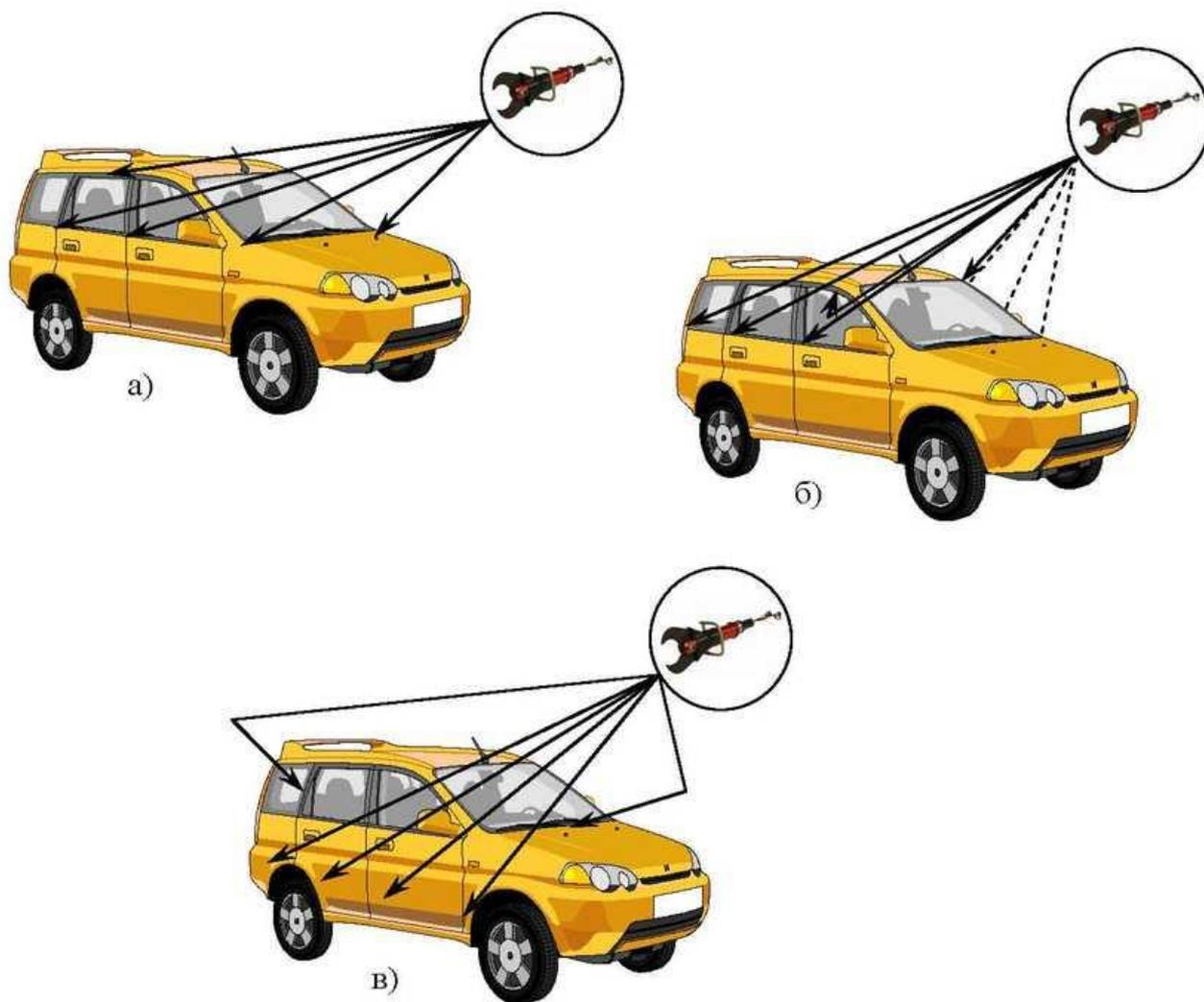
Рис. 9. Места кузова автомобиля, перекусываемые при отгибе крыши: а) назад; б) вперед; в) вбок
