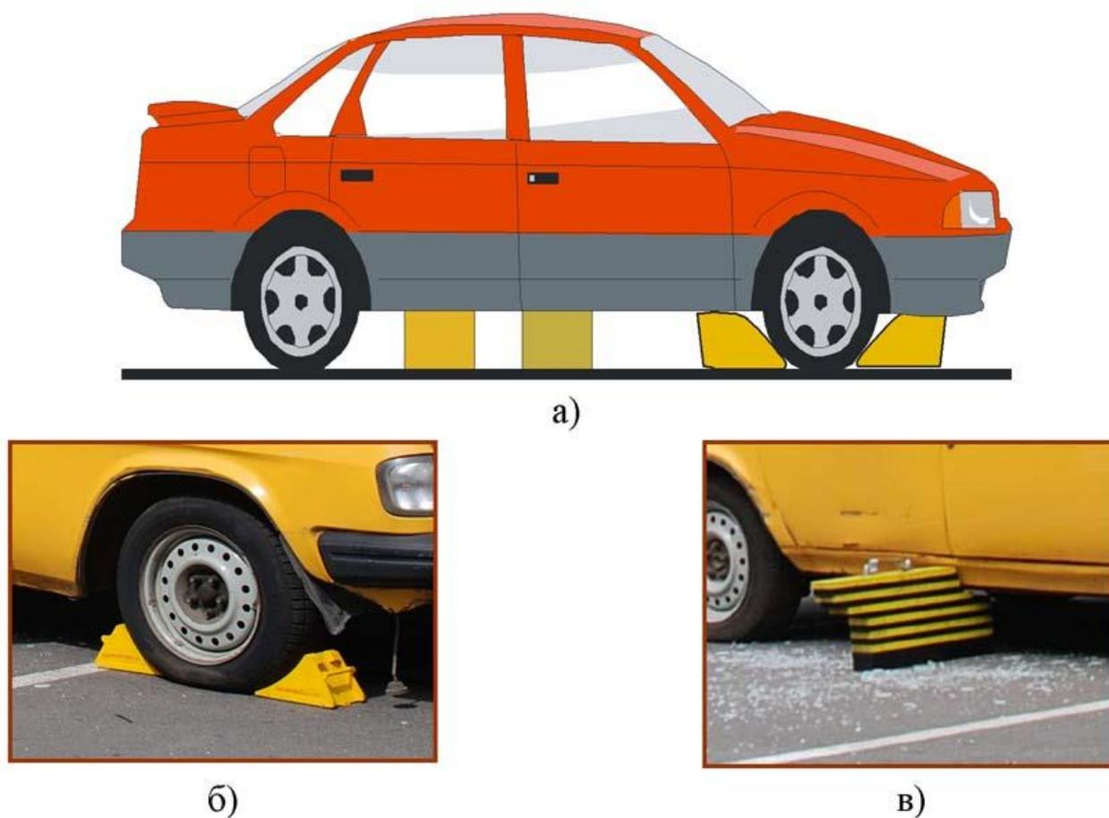
Рис. 5. Стабилизация аварийного ТС, стоящего на колесах:
