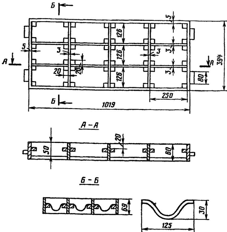
Рис. 2. Конструкция кассеты с формами
