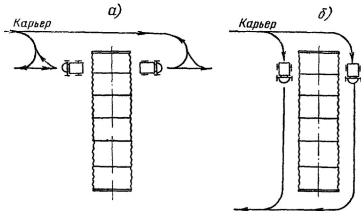
Рис. 12. Схемы движения автосамосвалов в процессе отсыпки грунта
