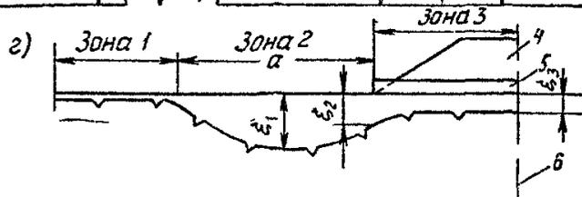
Графики для определения расчетной глубины протаивания грунтов ( $\xi_1$ ,  $\xi_2$ ,  $\xi_3$ ) в зависимости от среднегодовой температуры  $t_B$  воздуха  $\xi = f(t_B)$ :
