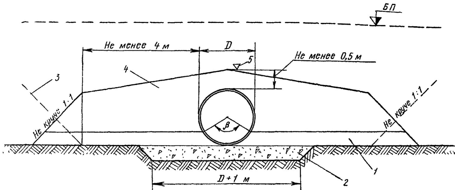
Рис. 4. Конструкция грунтовой призмы металлических гофрированных труб:
