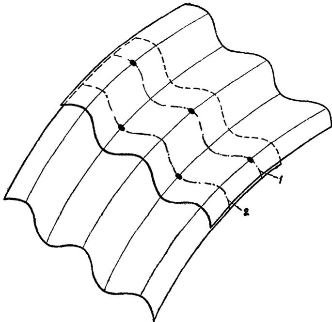
Рис. 8. Схема размещения болтов продольного стыка
