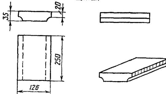
Рис. 1. Типы сборных асфальтобетонных блоков
