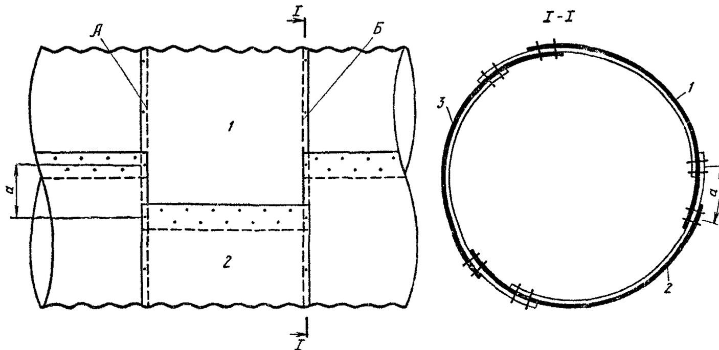
Рис 9. Схема соединения двух секций соединительными элементами
