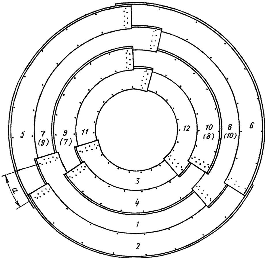
Рис. 10. Монтажная схема трубы отверстием 1,5 м (вид с торца):
