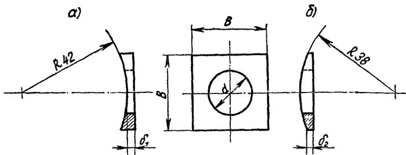
Рис. 5. Шайбы для болтов (размеры в миллиметрах):
