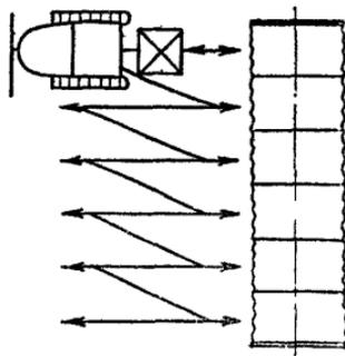
Рис. 13. Схема уплотнения грунта виброударной машиной челночным способом
