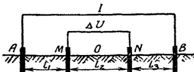
Схема для определения удельного сопротивления грунта
