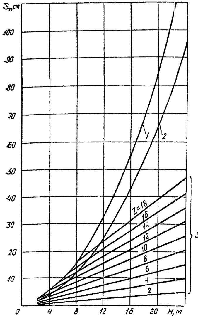
Рис. 1. Расчетный график для определения осадок труб:
