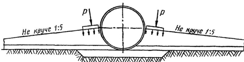
Рис. 11. Схема засыпки и уплотнения грунта наклонными слоями
