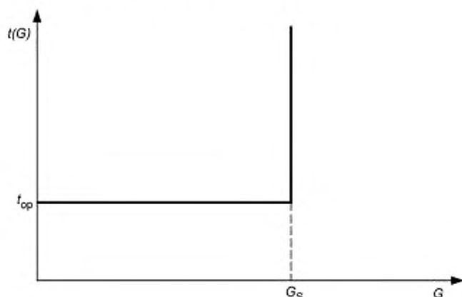
Рисунок 3 — Независимая характеристика времени реле минимального тока
