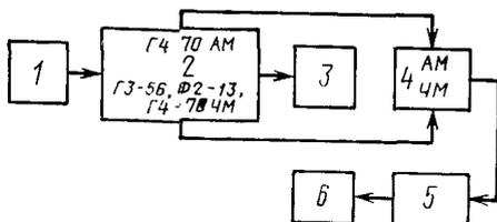
1—генератор типа Г3—56; 2—фазовращатель, входящий в комплект СКЗ—40; 3—фазометр типа Ф2—13; 4—генератор типа Г4—70; 5—поверяемый прибор; 6—анализатор спектра типа С4—34.
