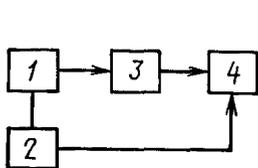
1—генератор сигналов типа Г4—70; 2—генератор сигналов типа Г3—102 или типа Г3—35; 3—поверяемый прибор; 4—фазометр типа Ф2—13.
