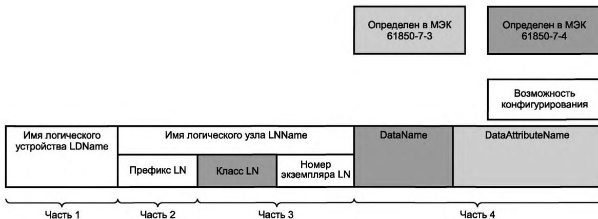
Рисунок 5 — Элементы идентификации сигнала согласно определению МЭК 61850-7-2
