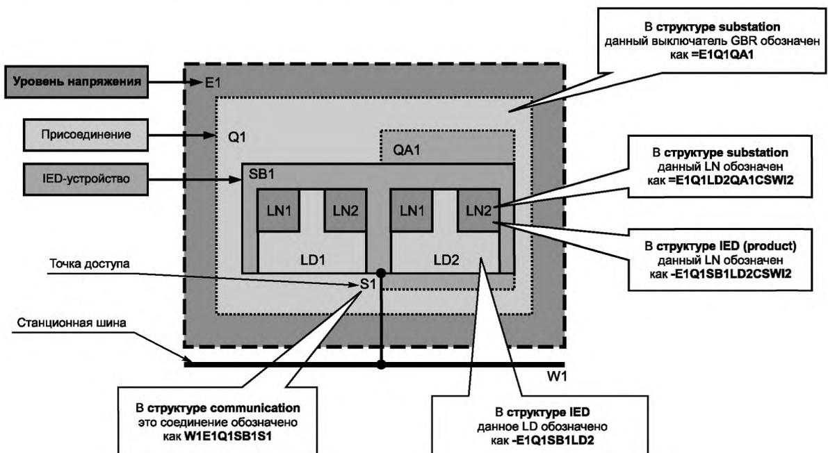
Рисунок 8 — Имена в различных структурах объектной модели
