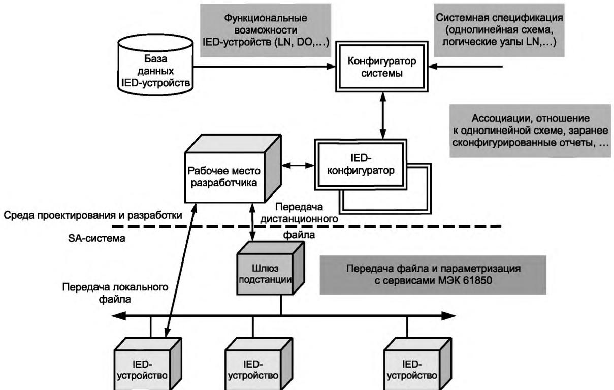
Рисунок 1 — Эталонная модель потока информации в процессе конфигурирования
