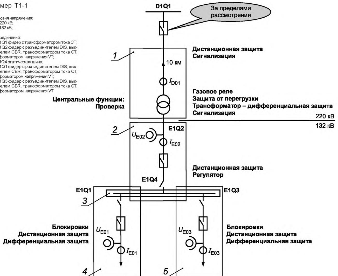
Рисунок D.1 — T1-1. Конфигурация подстанции
