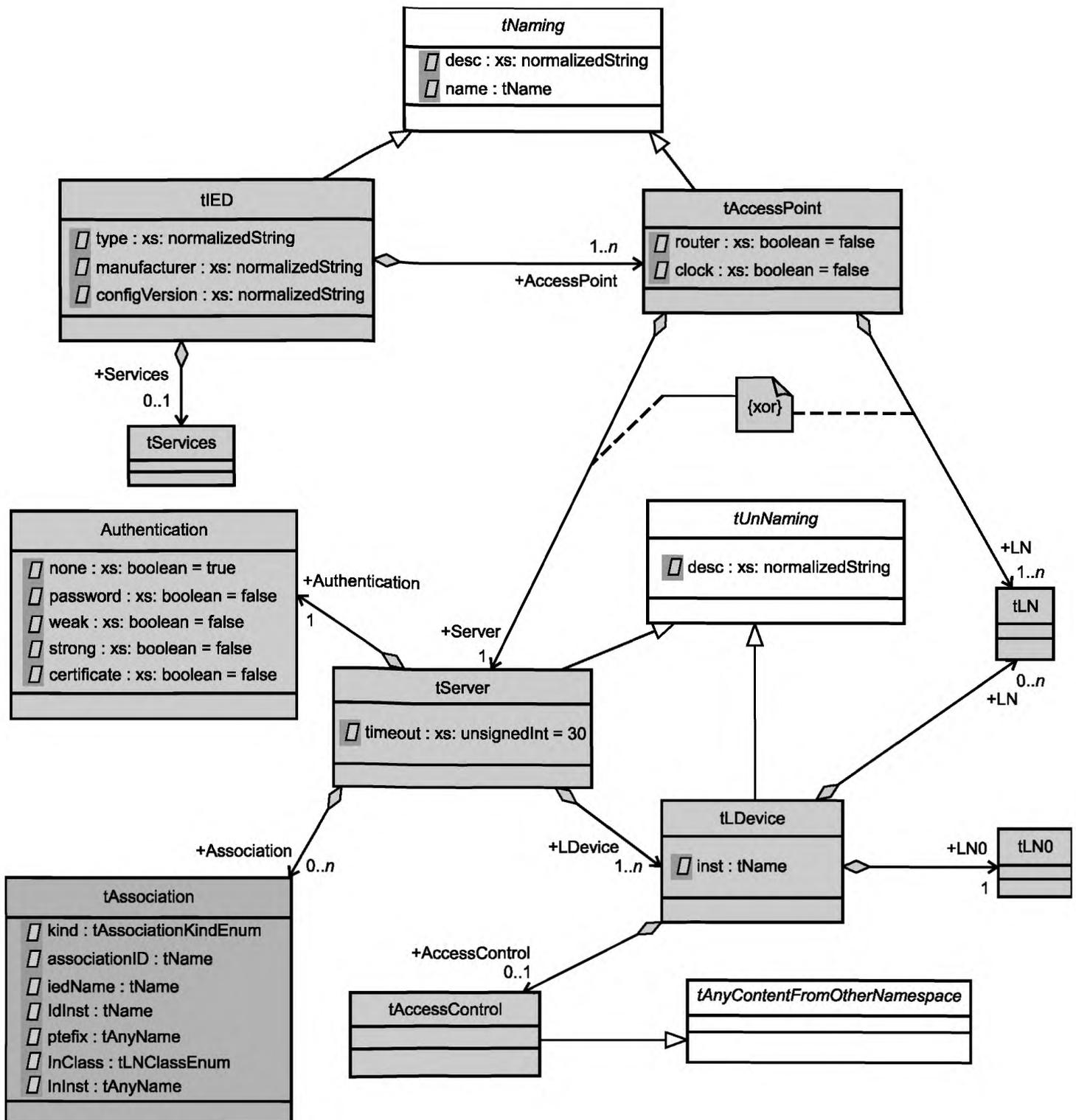
Рисунок 13 — UML-описание части схемы, относящейся к IED-устройству, — база
