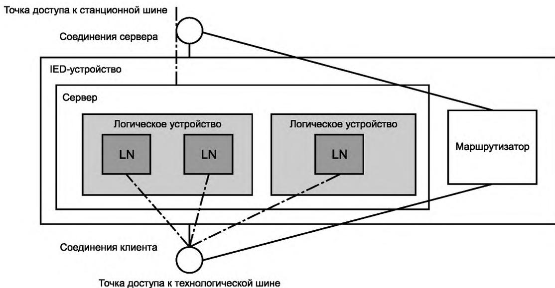
Рисунок 12 – Структура IED-устройства и точки доступа
