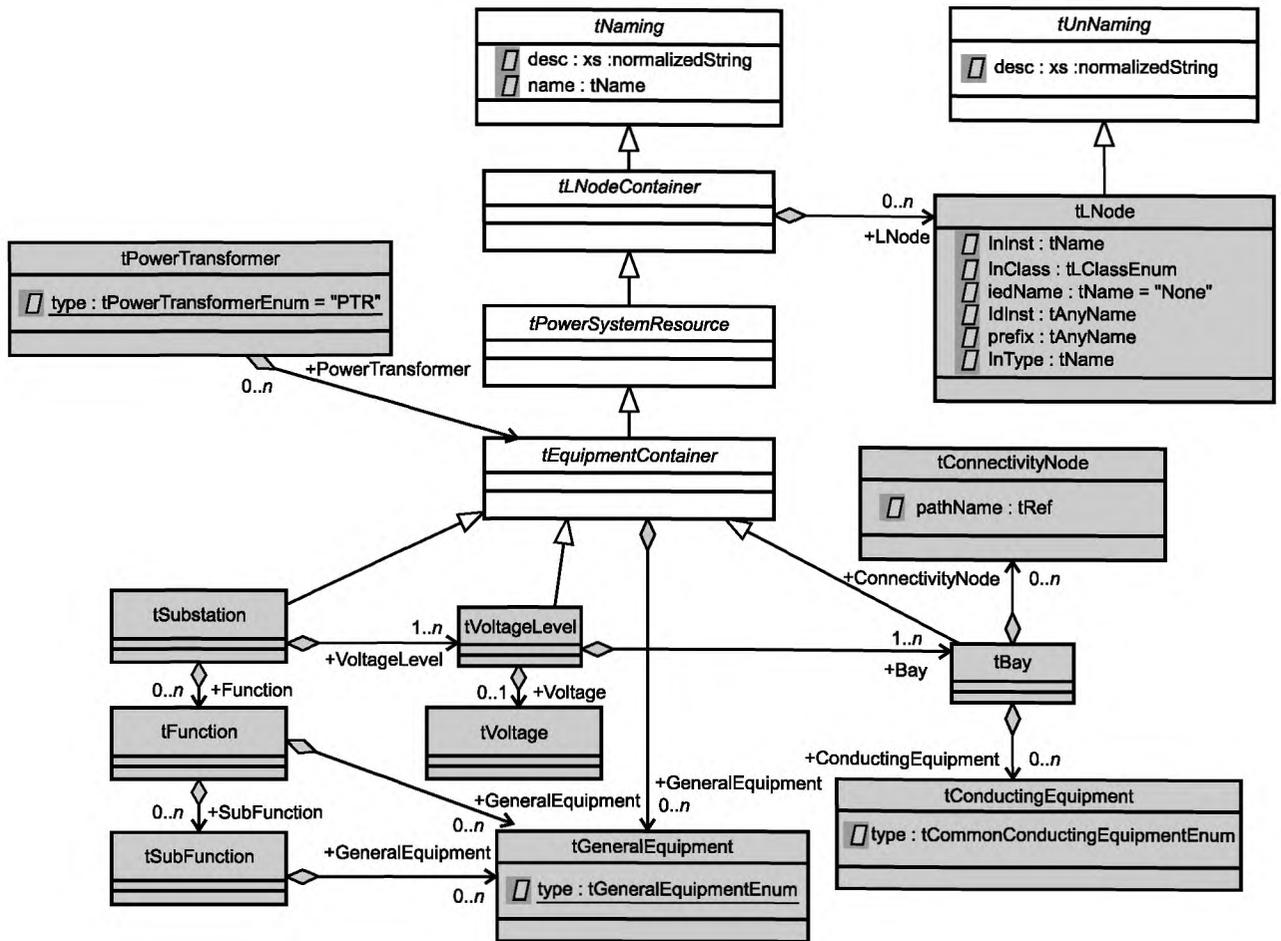
Рисунок 10 — UML-схема секции Substation
