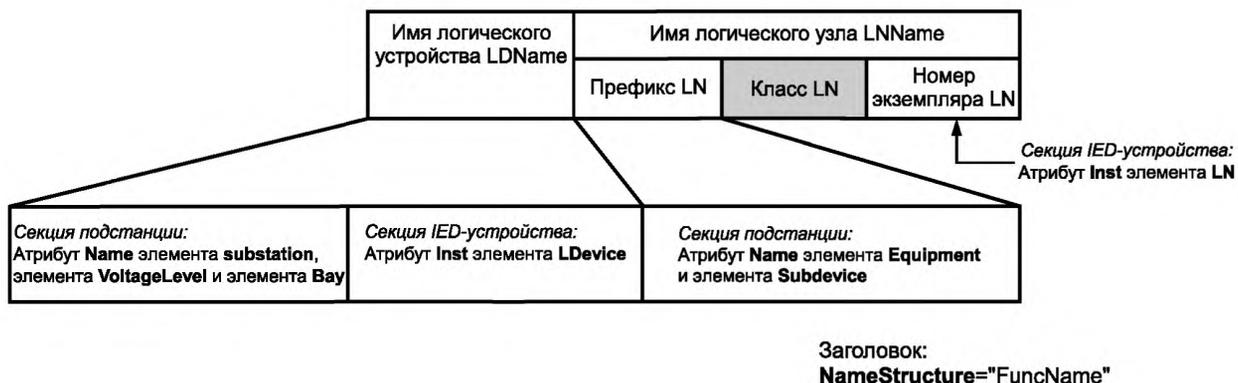
Рисунок 6 — Элементы имени сигнала при функциональном присвоении имен
