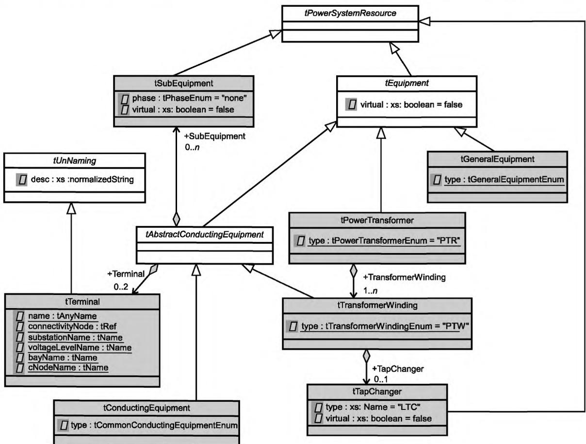
Рисунок 11 — UML-схема. Наследование типов оборудования и отношения
