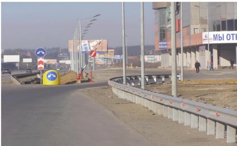
Рисунок 10 – Фронтальное дорожное ограждение в виде буфера на автомобильной дороге М-9 «Балтия»
