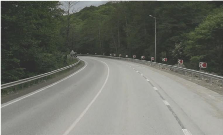
Рисунок 2 – Металлическое барьерное одностороннее дорожное ограждение
