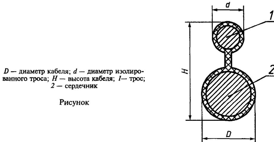
$D$  — диаметр кабеля;  $d$  — диаметр изолированного троса;  $H$  — высота кабеля; 1 — трос; 2 — сердечник
