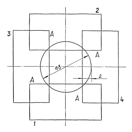
«1- 4» - положения плоскопараллельной концевой меры длины
