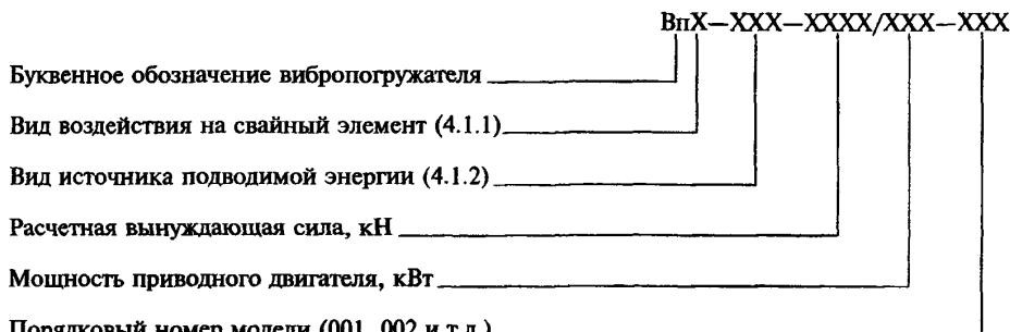
Пример условного обозначения безударного гидравлического вибропогружателя с мощностью приводного двигателя 160 кВт, расчетной вынуждающей силой 1250 кН второй модели:
