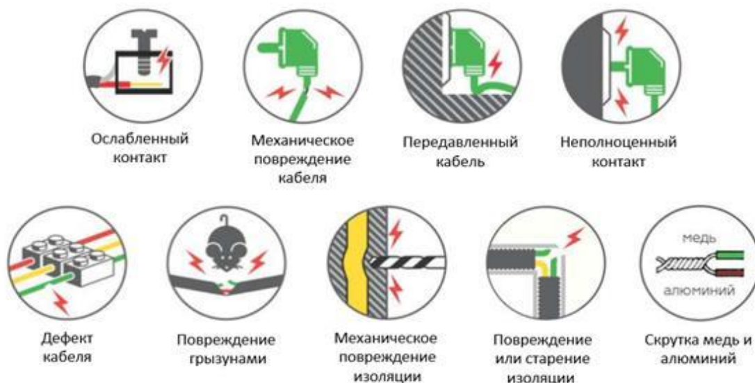
Рисунок 6. Возможные причины искрения в электропроводке
