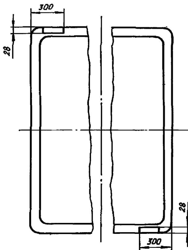
На поддоне ПА-5,6 маркировка может наноситься, помимо верхней поверхности бокового профиля, на торцевых поверхностях.
