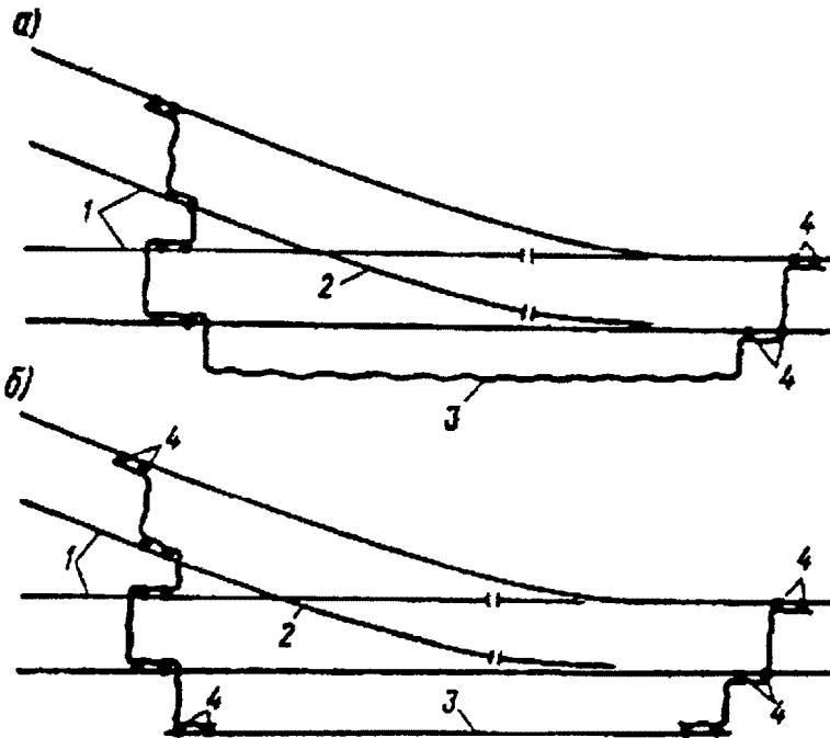
Рисунок 5. Схема установки временных продольных перемычек при смене одного из крайних стрелочных переводов:
