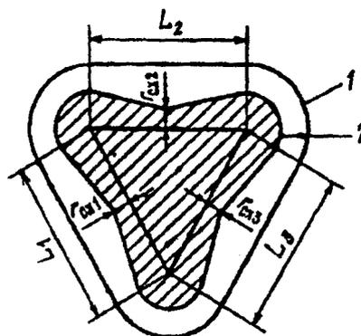
Рисунок 10. Схема зоны защиты (в плане) многократного стержневого молниеотвода:  $L_1, L_2, L_3$  - расстояния между молниеотводами; 1, 2 - границы зон защиты на уровнях соответственно земли и высоты защищаемого сооружения
