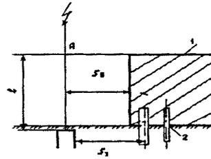
Рисунок 1. Отдельно стоящий стержневой молниеотвод: 1 - протяженность токопровода от точки А до заземлителя;  $S_6$  - наименьшее допустимое расстояние до защищаемого сооружения;  $S_3$  - наименьшее допустимое расстояние от заземлителя до металлических коммуникаций; 1 - защищаемое сооружение; 2 - металлические коммуникации
