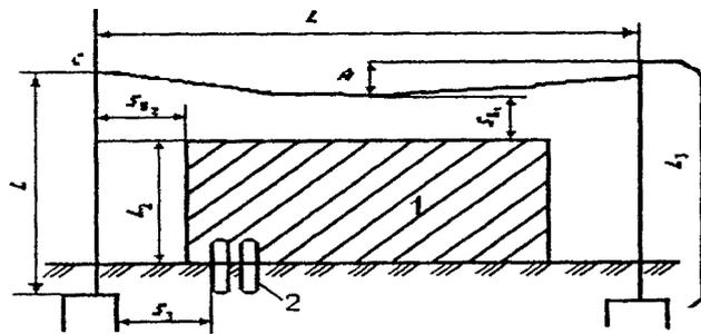
Рисунок 2. Отдельно стоящий тросовый молниеотвод: 1 - расстояние между молниеотводами;  $l_1, l_3$  - протяженность токопроводов;  $l_2$  - высота защищаемого сооружения;  $S_{61}, S_{62}$  - наименьшие допустимые расстояния от тросового молниеотвода соответственно в точках А и С до защищаемого сооружения;  $S_3$  - наименьшее допустимое расстояние от заземления до металлических коммуникаций; 1 - защищаемое сооружение; 2 - металлические коммуникации
