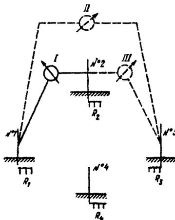
Рисунок 17. Схема измерения сопротивления заземлителей способом трех измерений
