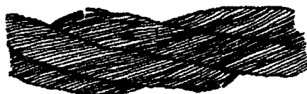
Рисунок 1. Обрывы и смещения проволок каната крестовой свивки
