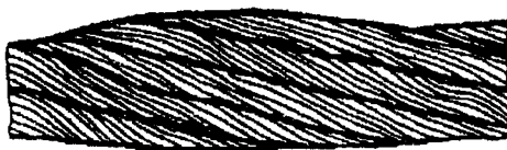
Рисунок 13. Местное увеличение диаметра каната
