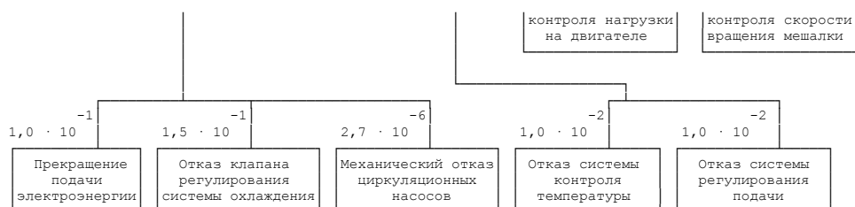
Рис. 8-1. Пример дерева отказов для химических реакторов
